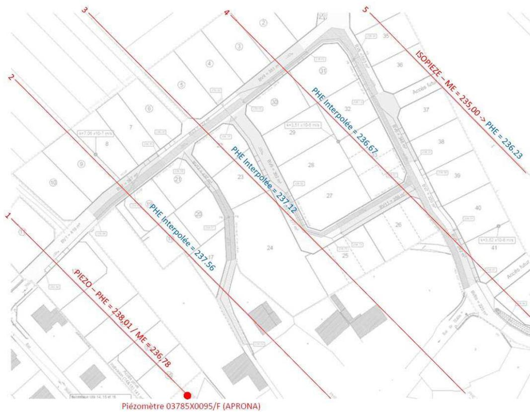
La cote des plus hautes eaux (PHE) relevée par le piézomètre s'élève à 238.01 m et celle des moyennes à eaux ME à 236.78 m.
